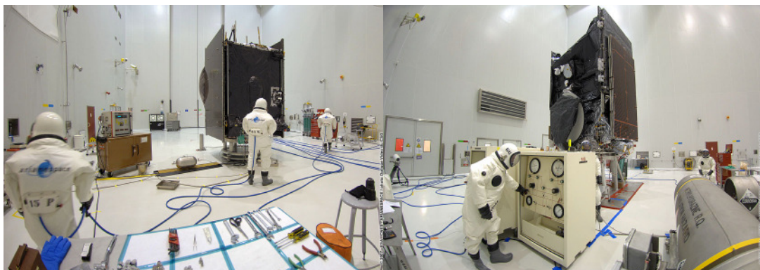
BSAT-3A en cours de remplissage des réservoirs
