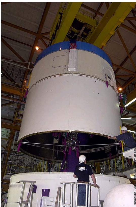
Kourou : érection de l'ESC-A dans le Bâtiment d'intégration Lanceur (BIL) © ESA/ARIANESPACE/Service optique CSG
