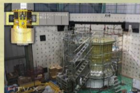
2020年10月 SM構体認定試験(静荷重試験)
