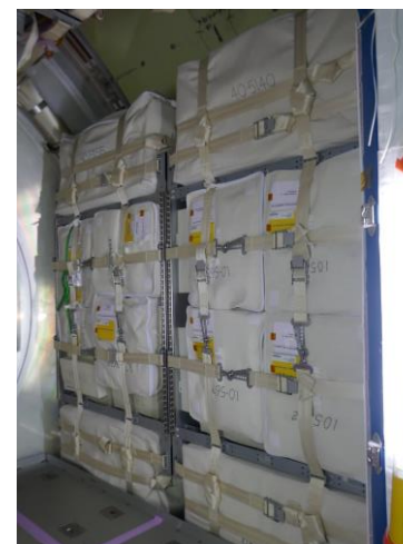
与圧モジュール内部の様子 カーゴ搭載構造(HRR)内部だけでなく HRRの上部/下部/前面にもカーゴを搭載し、 与圧モジュール内部の空間を埋め尽くします。
