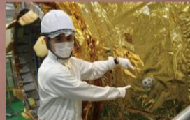
2022年6月 Mt.FUJIを1号機PMに取付け
