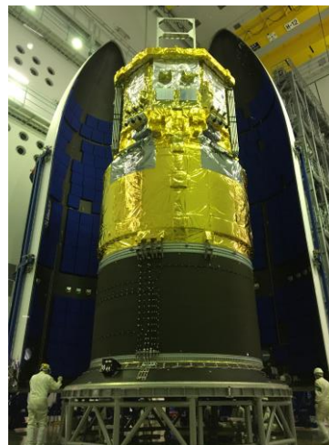
フェアリングへの収缶作業
