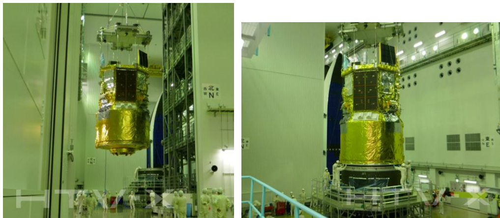
HTV-X全体を吊り上げ、H3側PAF(衛星分離部)と結合する作業
